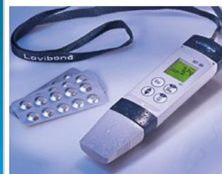
Der SD90 besteht aus einer Reihe kompakter, einfach zu bedienender, tragbarer Geräte für die genaue Messung von Salz.
