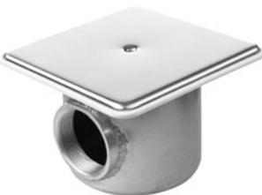
Zum Einbau in die Beton-Bodenplatte, mit Anti-Wirbel-Deckel in einem Kunststoff-Rahmen. Seitlicher Abgang in 2" Innengewinde.
