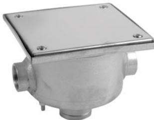
Zum Verdrahten von Unterwasser-Scheinwerfern, aus V2A-Edelstahl, mit zwei PG-16-Verschraub. und einem R 3/4" IG-Anschluss.
