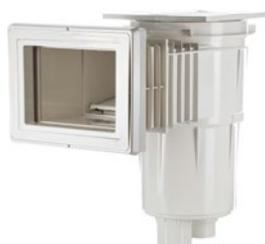
Skimmerkorb mit Bajonett-Halterung. Anschluss-Möglichkeit: 1,5" und 2". Saugbreite 209 mm, Saughöhe 144 mm.
