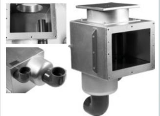
Skimmer aus Edelstahl in V4A-Qualität für den Einbau in Betonpools mit einer Einbautiefe von 240 mm, Saugbreite ca. 190 mm.
