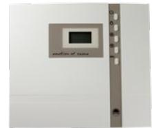
Elektronisches Steuergerät mit 24h-Echtzeit. Für Saunen mit und ohne Feuchtbetrieb. Regelbereich zwischen 30°C-70°C und 40°C-115°C. 5-Stufen-Feuchte-Taktung mit Wassermangel-Erkennung, Nachheiz- und Lüfter-Funktion.
