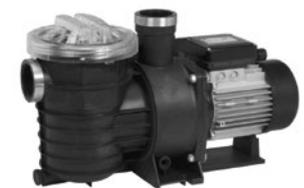
Selbstsaugende Blockpumpe. Eingebauter Vorfilterkorb und Klarsicht-Schraubdeckel. Entleerungs-Schraube direkt am Gehäuse.
