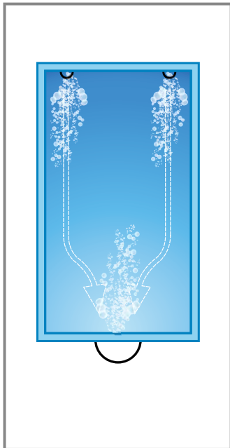
Längsdurchströmung mit Einbau-Skimmer und 2 Einlaufdüsen
