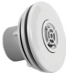
Die Öffnung der Multiflow Kugel (d=14mm) kann mit Hilfe des Stempels auf 20 / 25 mm vergrößert werden (höherer Durchfluss).
