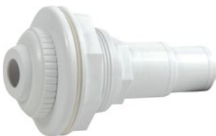
Einlaufdüse mit Flansch-Dichtung und 1 1/2" Innengewinde und Schlauchstützen. 1 1/2" AG x 38 mm.
