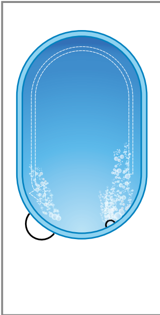
Kreisströmung mit Einbau-Skimmer und Einlaufdüse
