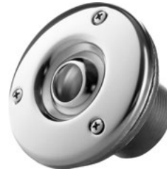
Mit Außengewinde in 1 1/2 Zoll x 50 mm Gewindelänge, einer Einlaufkugel aus Edelstahl mit 20 mm Öffnung. Material: V4A.
