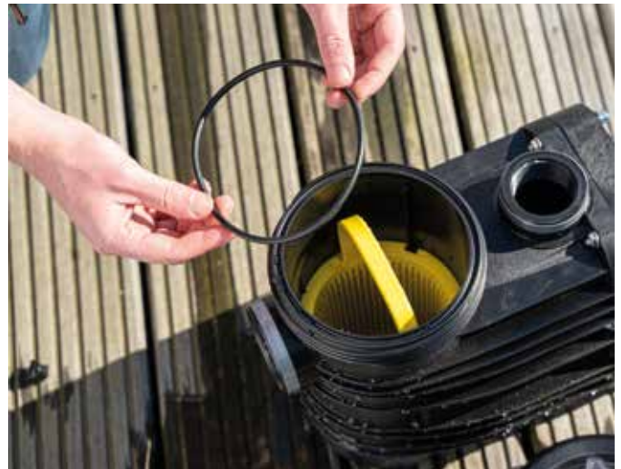
Austausch der Dichtungen: Alle Dichtungen sind Verschleißteile und sollten regelmäßig überprüft werden. In unserem Video (siehe unten) erfahren Sie, wie das geht.
