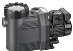
Speck Pumpe 90/7 230 Volt 0,25 kW 7 m³/h bei 8 Meter Wassersäule
