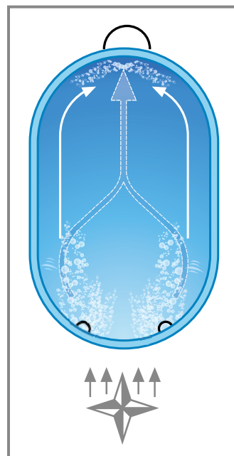
Einbau-Skimmer und 2 Einlaufdüsen (Pool 7,25m x 4,60m und 8,55m x 5,00m)
