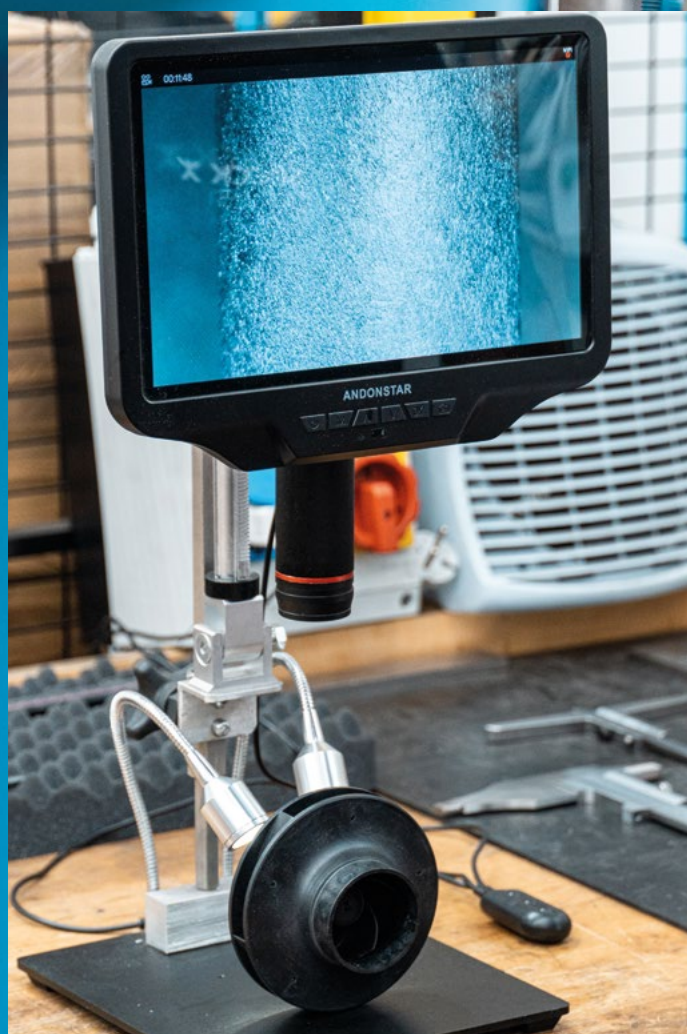
Mit Hilfe von elektrischen Mikroskopen können feinste Fehler ausfindig gemacht werden.
