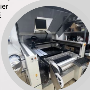
SMD-Bestückungsmaschine. Mit der Maschine werden Bauteile auf Platinen gesetzt.
